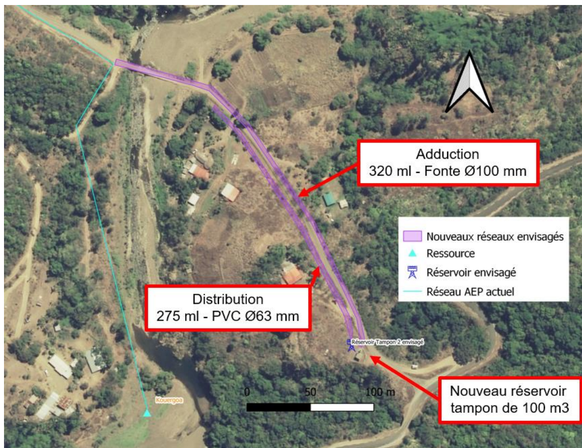
Figure 51 Travaux envisagés sur les réseaux de Kouergoa
