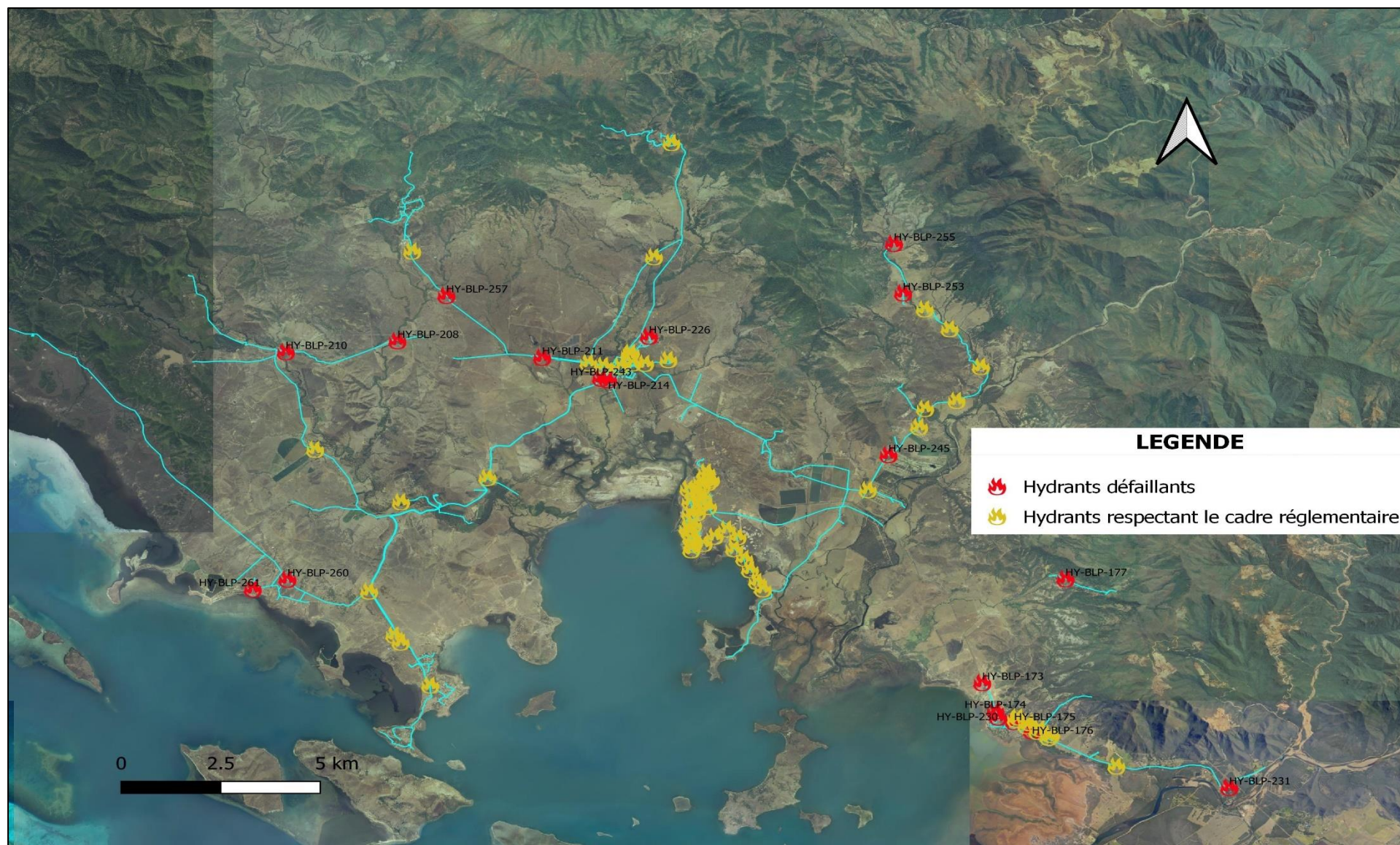
Figure 63 Diagnostic des hydrants du réseau de Boulouparis
